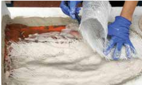
6 Druk de A1 Triaxial glass fibre in de nog natte A1. Ga door tot de hele siliconenmal bedekt is met A1 en een laag A1 Triaxial glass fibre.
