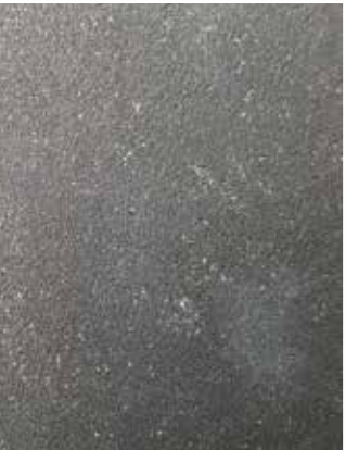
A1 paneel met zand na vijf jaar blootstelling aan het weer.
