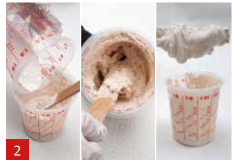
2 Voeg zoveel A1 ATP powder als nodig is bij de A1. Daarna stevig roeren tot alle klontjes verdwenen zijn. De A1 kan zo dik als pasta of als stopverf worden gemaakt.
