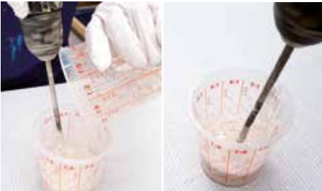
4 Voeg de A1 Powder voorzichtig toe aan de A1 Liquid. Roer tot alle klontjes verdwenen zijn (ong. 1 minuut) en het materiaal glad is.
