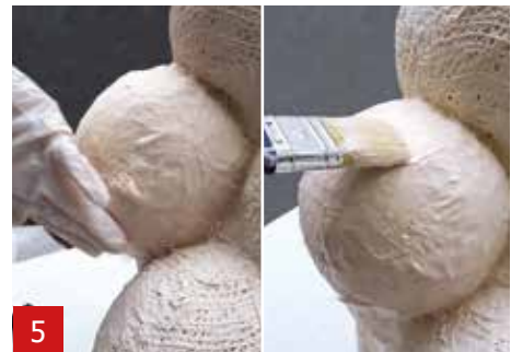
5 Het C-vlies moet met de hand of met een kwast met een laagje A1 bedekt worden.
