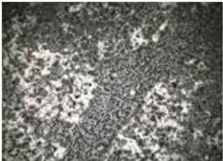
Uitvergroting van A1 panelen met A1 Sealer na vier jaar aan de zonkant
