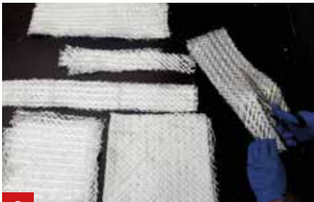
2 Knip de A1 Triaxial glass fibre in verschillende maten, genoeg voor 4 lagen.
