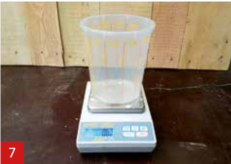
Zet een bakje op de weegschaal. Kalibreer de weegschaal samen met het bakje (0.0 g).
