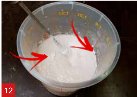
Blijf mengen tot alle klontjes verdwenen zijn (ong. 1 min.) en het materiaal helemaal glad is.
