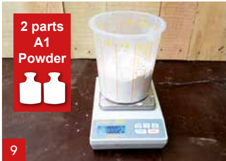
Weeg twee delen A1 Powder. In dit voorbeeld gebruiken we 1000 g A1 Powder.
