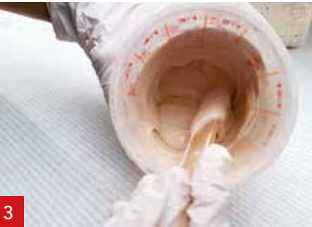
3 Meng de A1 Liquid, Thix A en A1 Powder tot een glad mengsel.
