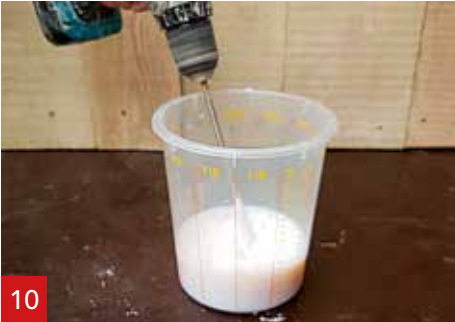
Zet de mixer (scheef) in de beker met A1 Liquid en creëer een kolk.
