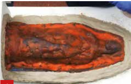
1 Stabiliseer de siliconenmal, alvorens de eerste steunmal te maken.
