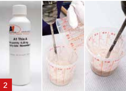
2 Voeg 2% (van de totale hoeveelheid A1) Thix A toe aan de A1 Liquid. Het toevoegen van Thix A aan de A1 zal het product een dikkere structuur geven.
