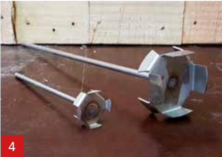
Gebruik de A1 mixer. Klein: tot 1,5 kg A1. Groot: 1,5 kg of meer A1.
