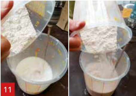
Voeg de A1 Powder voorzichtig toe aan de A1 Liquid.
