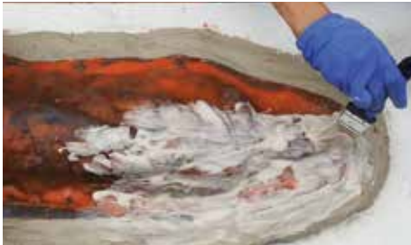
5 Breng de A1 met een kwast aan op de siliconenmal.
