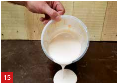
De A1 is klaar voor lamineren, gieten of spuiten. Verwerkingstijd 20 tot 25 minuten.
