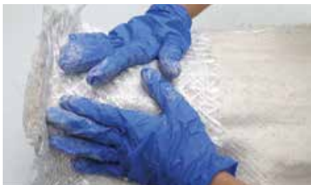
9 Druk de A1 Triaxial glass fibre stevig aan. Het weefsel laat zich goed vormen/modelleren.
